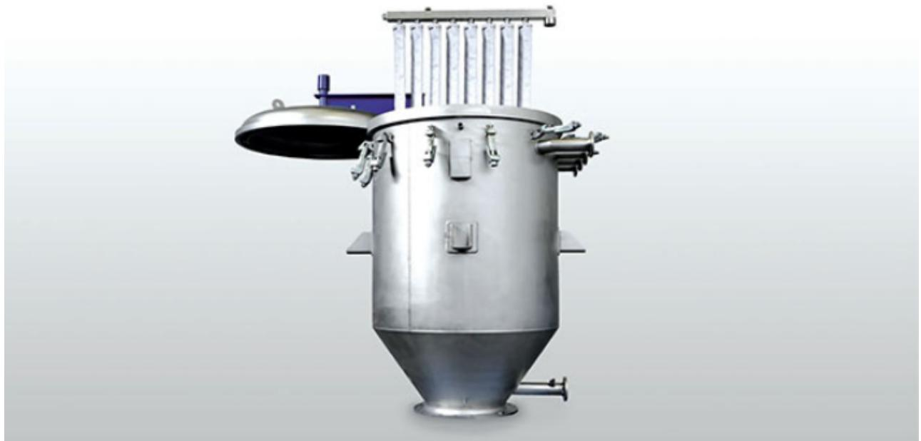
袋式过滤器在使用时都有哪些需要注意的事项呢？在袋式过滤器使用时，机器中的滤袋要先在与过滤液体匹配的预湿液中进行湿润几分钟，这样做的主要目的是提高滤袋的亲水性，帮助机器进行更好的过滤。而更换滤袋时，也需要到我们先打开过滤机的上盖，正如上文所述的上盖的正确处理方法。上盖打开后便可对滤袋进行更换，期间记得平稳取放。还有在使用袋式过滤器时，应该再需要注意监控其过滤的质量，定期检查机器的压差，以防止滤袋的破裂、液体的泄露等问题。还有O型密封圈的保养和更换等等。袋式过滤器的使用操作虽然简便灵活，但对于机器本身的注意事项以及保养维护要极度注意，以提高过滤器使用寿命的长久，支持过滤器能够更好的进行过滤工作。作为新型的过滤系统，袋式过滤器未来的发展也会越来越好，定期的维护以及注意使用中的关键事项都是很有必要的。润滑过滤器订做费用袋式过滤器是一种多用途过滤设备。
